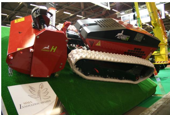
7. kép A Dargreen 45H bozótirtó robot
