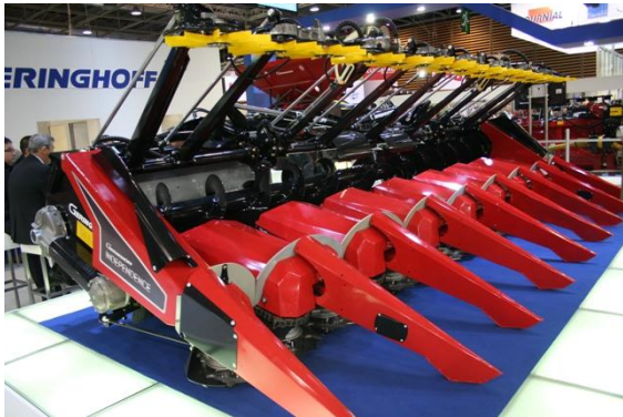
8. kép A Geringhoff innovatív kukorica-kombájn adaptere, a „Row Independent Corn Head”
